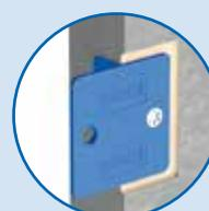
Eingefräste Kunststoff T-Profile zur Verbindung der Holzzementplatten. Eine Seite werkseitig vormontiert. Erzeugt eine 2 mm Dehnfuge zwischen den Platten.
