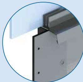
Brüstungskonsole wird mit UK Glasgeländer verschraubt.
